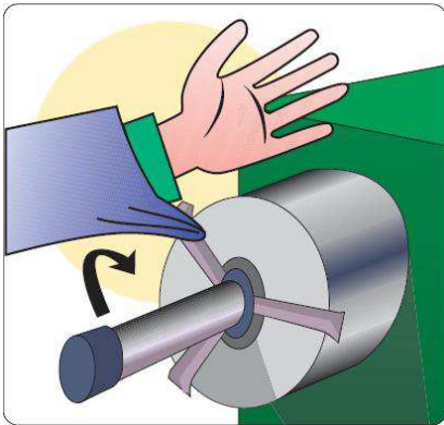
Impigliamento degli indumenti nel mandrino rotante con conseguente trascinamento nella rotazione .
