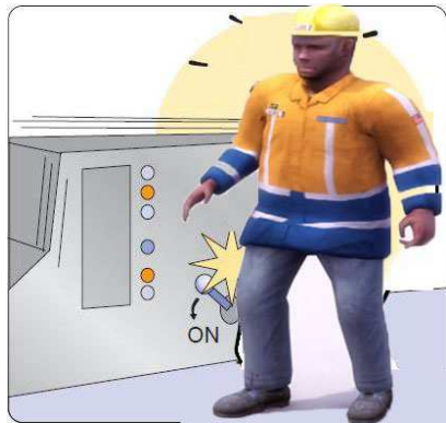
Avviamento accidentale della macchina , specialmente nei torni di vecchia costruzione dove il comando di messa in moto del mandrino è del tipo a leva sporgente .
